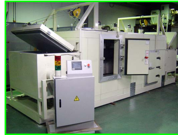
トンネルフリーザー外観
